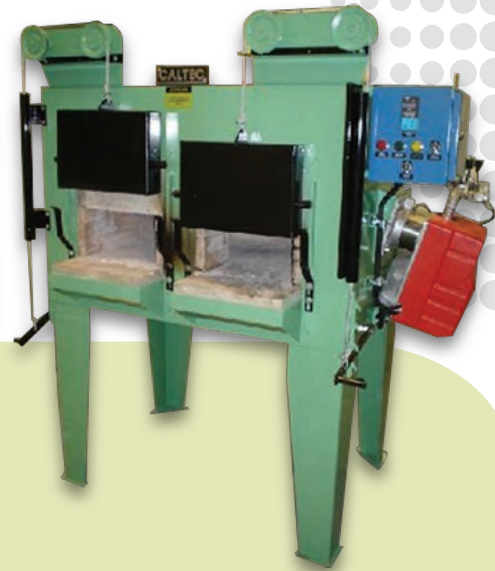
Horno doble puerta con quemadores de combustible líquido.
