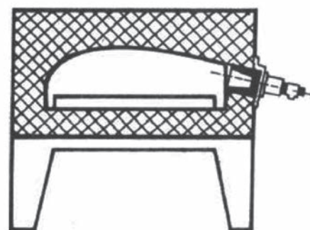
Sección del horno, donde se muestra la cámara, y la ubicación del quemador.
